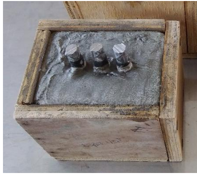
Figura 2. Bloco de concreto com três barras de aço da armadura.
