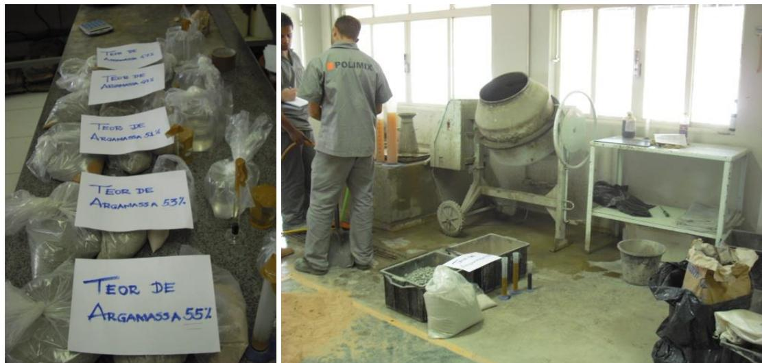
Figura 2. Dosificaciones con diferente proporción de mortero.
