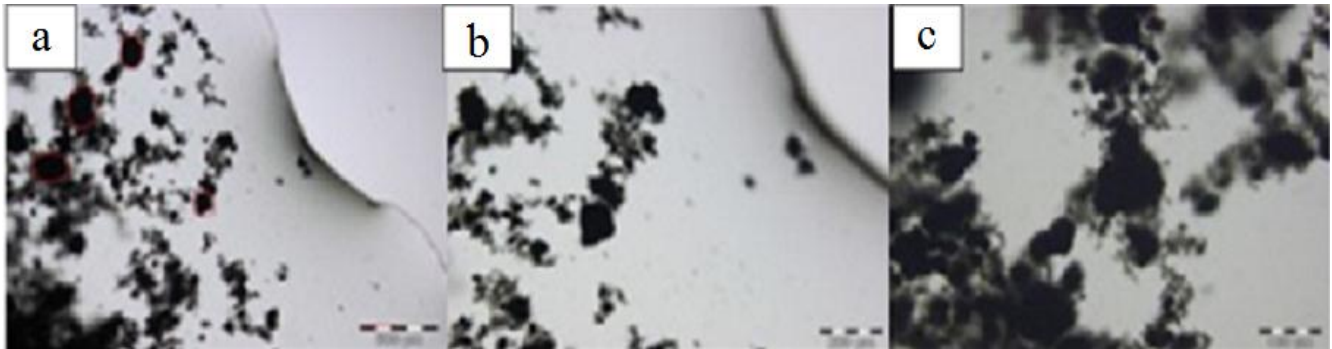
Figure 6. Muestra SM 2 – NTC en polvo disperso en agua y aditivo a base de policarboxilato (Tec Flow 8000 - 2%).
