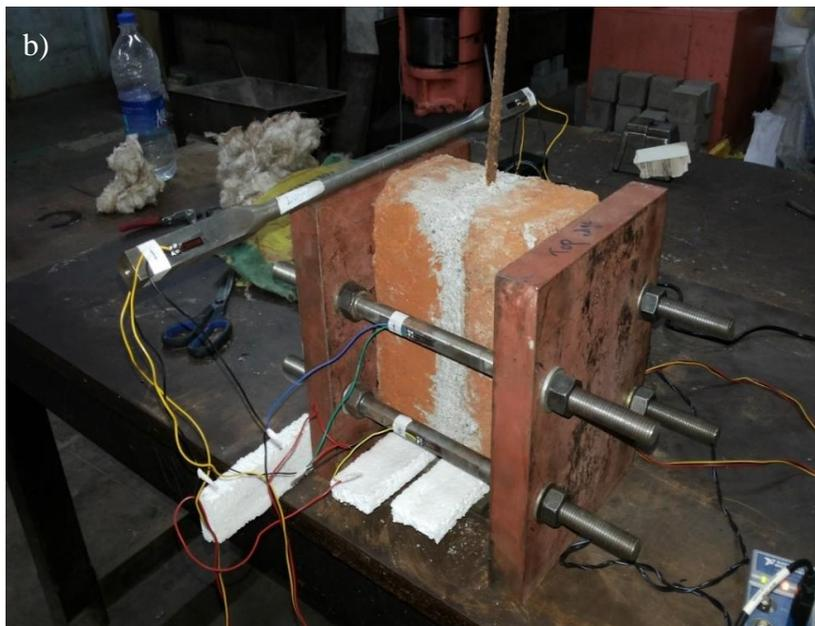
Figure 2. (a) Amostra mantida em posição (b) Configuração do ensaio de *pull-out*.
