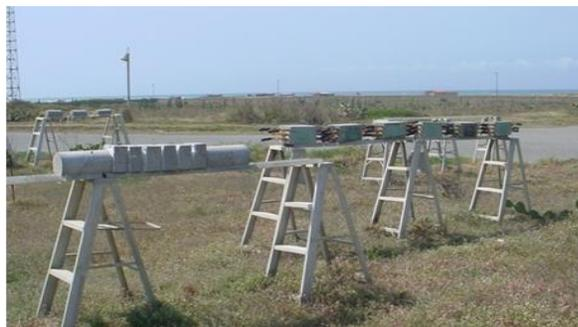
Figura 2. Estação de ensaio em ambiente marinho (La Voz)
