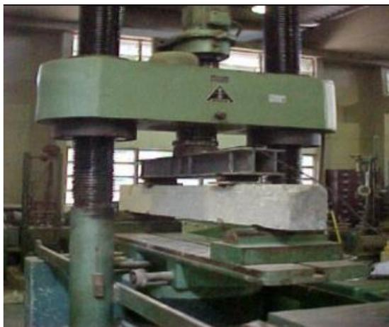
Figura 6. Prensa utilizada para los ensayos de flexión de vigas
