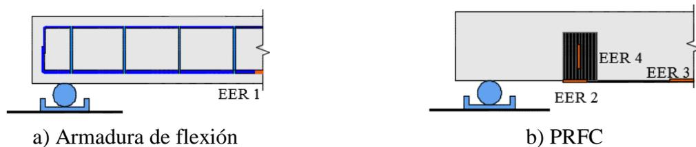
Figura 4. Instrumentación de las vigas.
