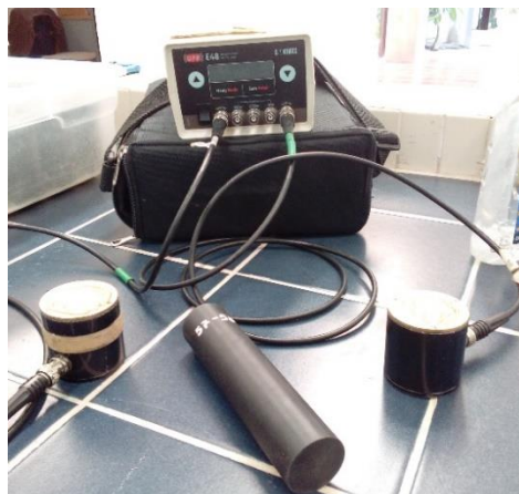
Figura 2. Equipamento utilizado para ensaio de UPV
