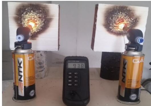
Figura 5. Aplicación de tinta intumescente.
