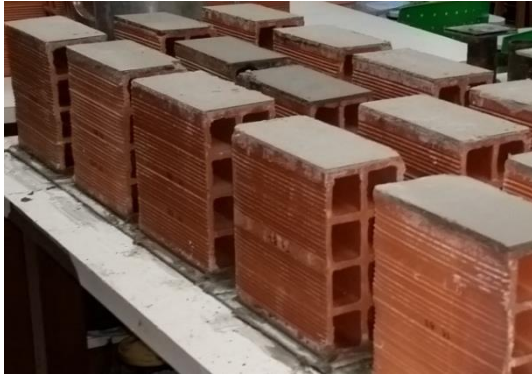
Figura 3. Copeamiento de bloques cerámicos.
