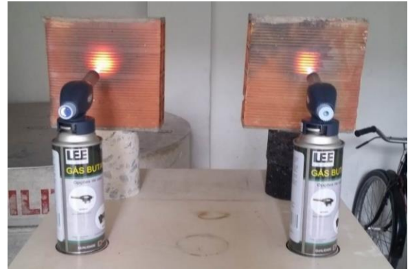
Figura 7. Bloques sin protección pasiva.
