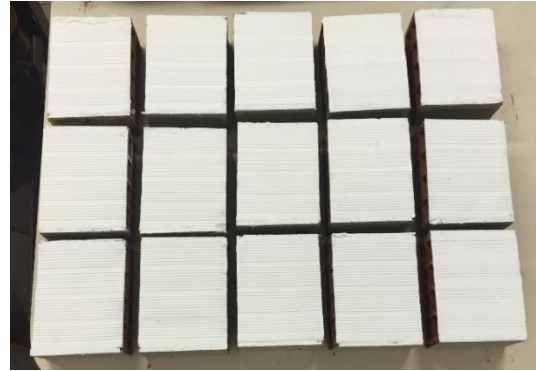
Figura 4. Aplicación de tinta intumescente.
