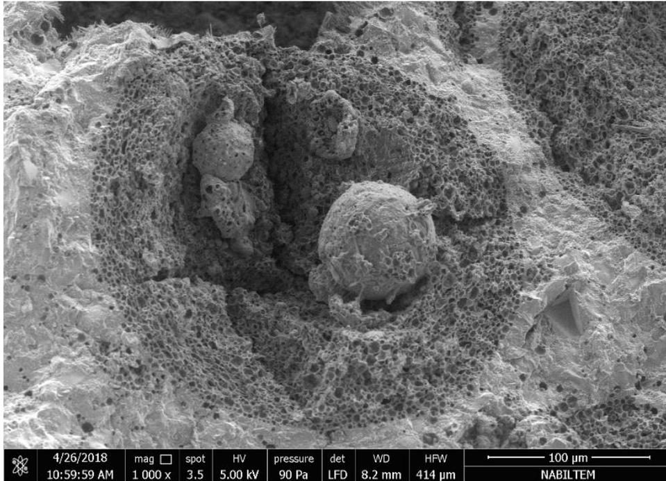
Fig. 6. PCM microencapsulado em matriz de cimento.
