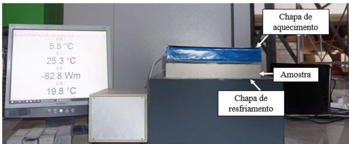
Fig. 2. Configuração do ensaio de condutividade térmica.
