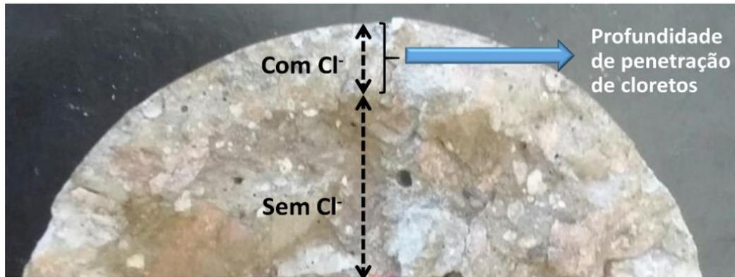
Figura 1. Medida da profundidade de penetração de cloretos pelo método colorimétrico visual por aspersão de solução aquosa de  $\text{AgNO}_3$  0,1 M.
