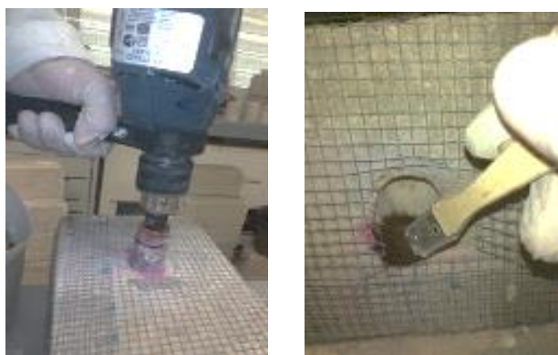
Figura 3. Extração de testemunhos e amostras de pó.
