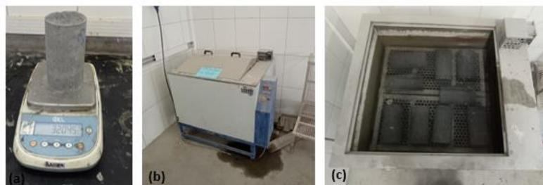
Figura 3. Pasos para realizar la prueba de absorción y relación de vacíos
