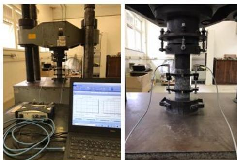
Figura 6. Prueba de módulo elástico
