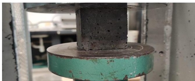
Figura 5. Máquina Universal de Pruebas, Resistencia a compresión uniaxial (UCS).
