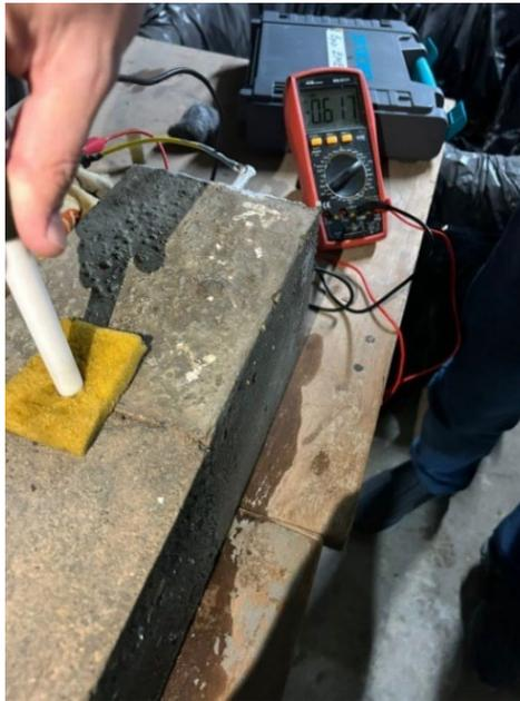
Figura 5. Apararelhagem para a realização dos ensaios de potencial de corrosão ( $E_{corr}$ ).
