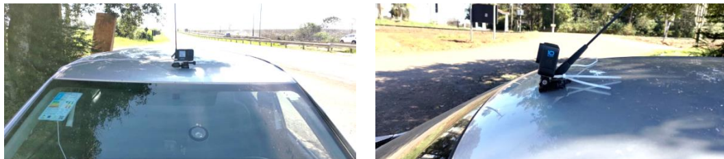
Figura 3. Posicionamiento de la cámara en el vehículo
