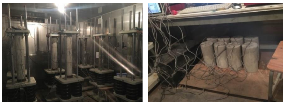
Figura 8. Ensaios de fluência e retração em tempo real sob ambiente totalmente controlado. Seul, Coreia.
