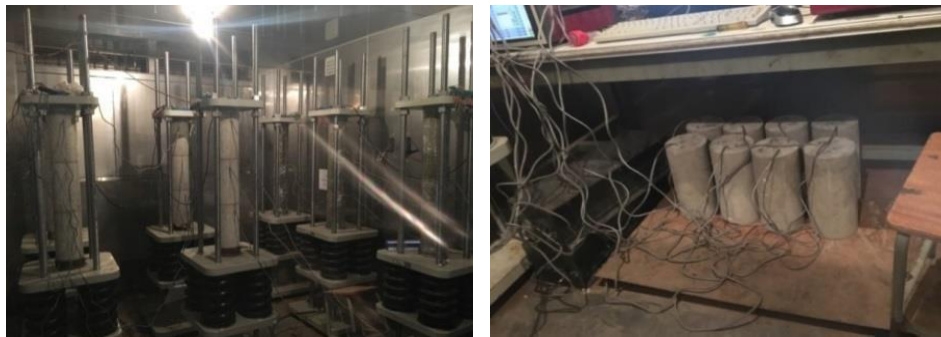
Figura 8. Pruebas de fluencia y contracción en tiempo real en un entorno totalmente controlado. Seúl, Corea.
