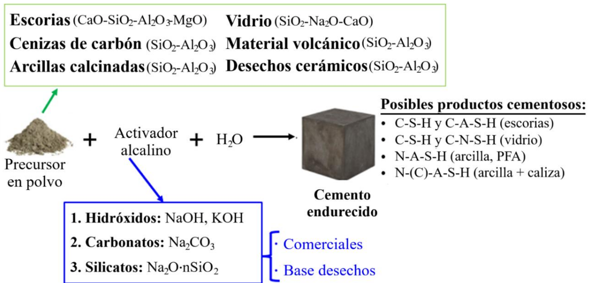
Figura 3. Esquema de reacción de Cementos alcalinos de “una parte”. En los cementos de dos partes, el activador alcalino se añade predisoluto con el agua de la mezcla.
